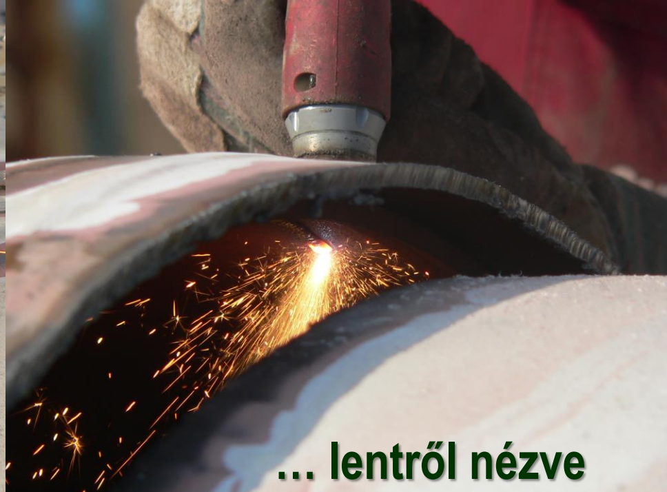
6 mm vastag szénacél lemez kézi plazmavágása fentről nézve
