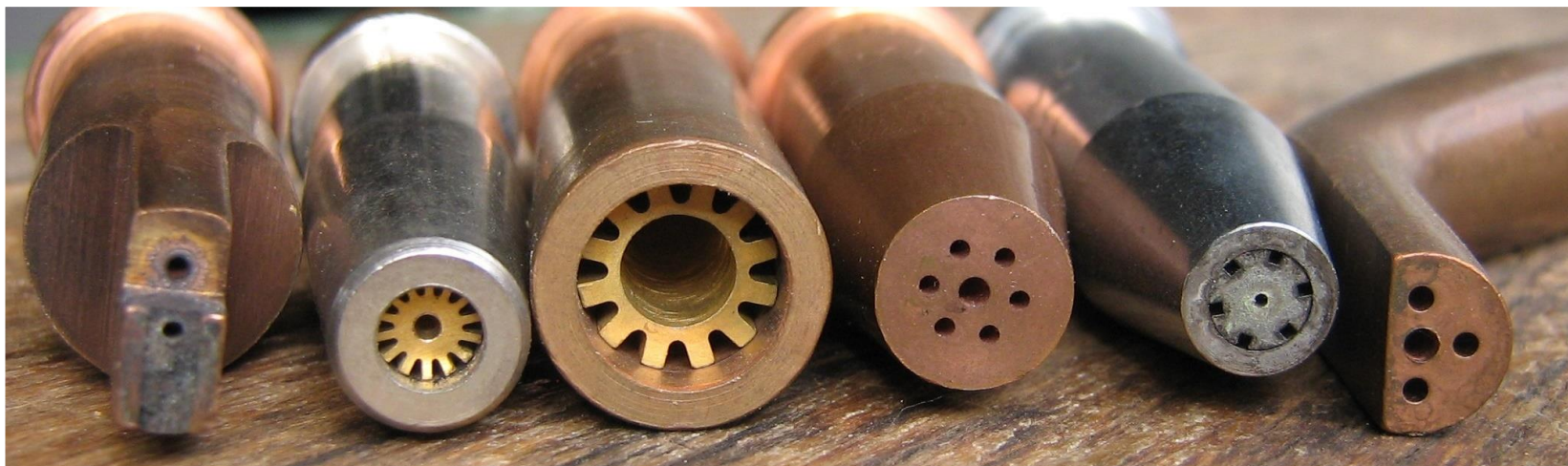
a) egyrészes, b) szita-, c) hornyos, d) réselt, e) gyűrűs fúvóka
